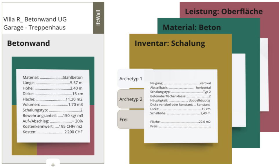
Abbildung 3: Beispiel Komposit Betonwand
